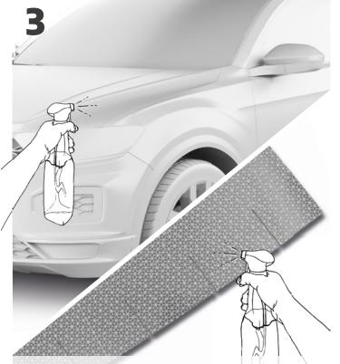
Besprühen Sie mit dem Applikationsspray sowohl den Untergrund als auch (nach dem Entfernen des Silikonpapieres) die klebende Seite der Folie. Durch vorsichtiges Schieben können Sie die Warnmarkierung nun verkleben.
