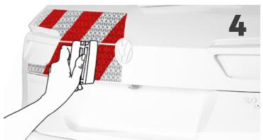
Streichen Sie mit einer Rakel und etwas Druck die überschüssige Flüssigkeit von der Mitte zum Rand hin aus.
