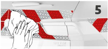
Um mögliche Wasserflecken um die Folie herum zu entfernen, trocknen Sie die Fläche vorsichtig mit einem Microfasertuch ab, damit die Kanten der Folie nicht angehoben oder beschädigt werden.
