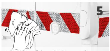
Um mögliche Wasserflecken um die Folie herum zu entfernen, trocknen Sie die Fläche vorsichtig mit einem Microfasertuch ab, damit die Kanten der Folie nicht angehoben oder beschädigt werden.
