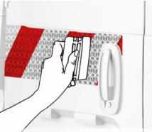
Streichen Sie mit einer Rakel und etwas Druck die überschüssige Flüssigkeit von der Mitte zum Rand hin aus.
