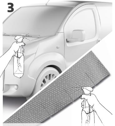
Besprühen Sie mit dem Applikationsspray sowohl den Untergrund als auch (nach dem Entfernen des Silikonpapieres) die klebende Seite der Folie. Durch vorsichtiges Schieben können Sie die Warnmarkierung nun verkleben.
