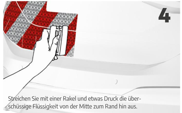
Streichen Sie mit einer Rakel und etwas Druck die überschüssige Flüssigkeit von der Mitte zum Rand hin aus.
