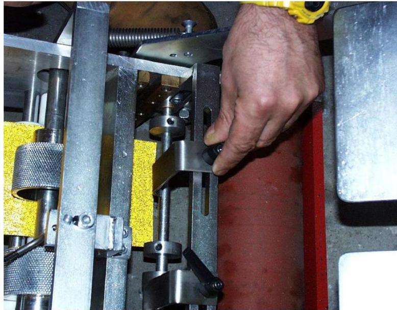
**ABB 6:** Justieren der vertikalen Folienführung
