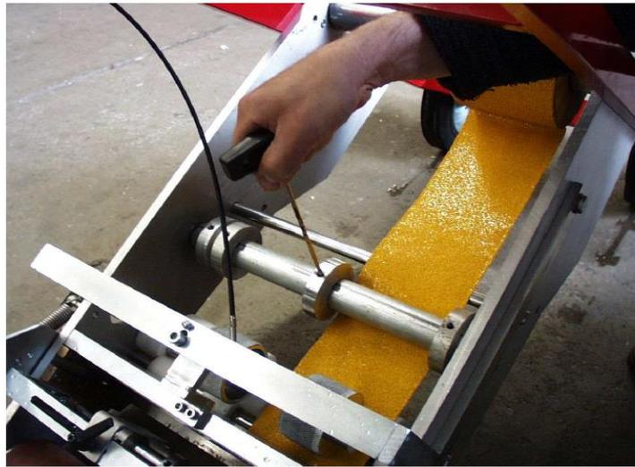
**ABB 3:** Justieren der oberen Folienführung
