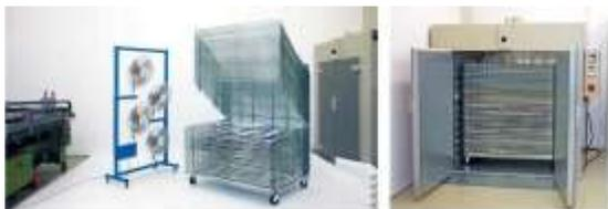
Eine weitere Optimierung der Trocknungsbedingungen ist durch den Einsatz von Konvektionsofen möglich. Diese abgeschlossenen Systeme ermöglichen eine staubarme Trocknungsphase bei konstanter Temperatur, geringer Luftfeuchtigkeit und ohne Belastung des Anwenders durch Lösungsmitteldämpfe.
