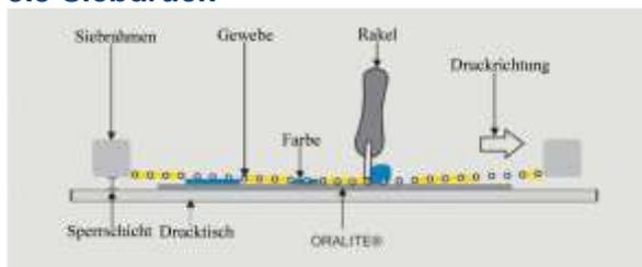
Vor dem Druckbeginn sind das Sieb, das Druck- und das Flutrakel mit einem geeigneten Lösungsmittel zu reinigen. Jede zu bedruckende Folie sollte außerdem mit einem Anti-Staub- bzw. Anti-Statik-Tuch behandelt werden.
