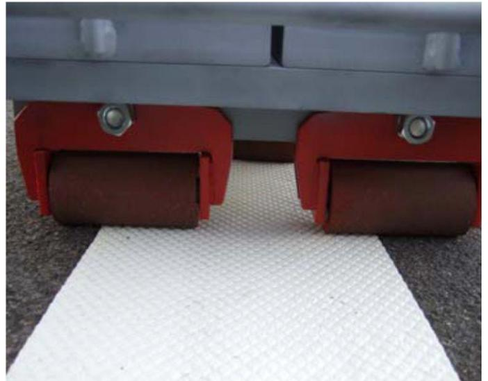
3M-Rollenandruckgerät RTC 3
